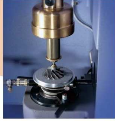
Ook hoogtoerige rotoren kunnen wij voor u balanceren, zoals bijvoorbeeld turbochargers bij toerentallen tot 200.000 t/min.
