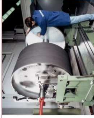
Flexibele rotoren zoals walsen of bovenstaande rollenset vereisen veel kennis en het juiste balanceergereedschap, zodat ze in de praktijk trillingsvrij draaien.
