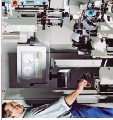
Het balanceren van hoogtoerige gereedschappen en gereedschapshouders verbetert de eenduidigheid van het verspaningsproces.
