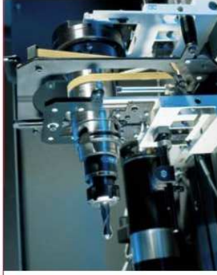
Het balanceren van hoogtoerige gereedschappen en gereedschapshouders verbetert de eenduidigheid van het verspaningsproces.
